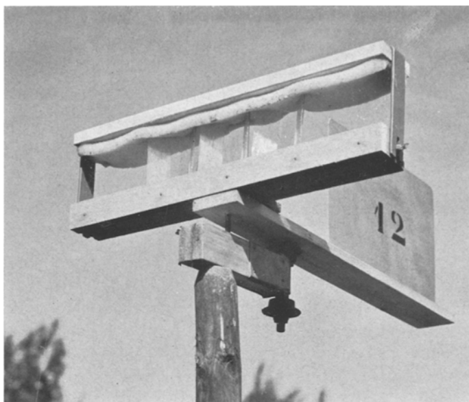
FIG. 2. Vangapparaat voor het nagaan van verplaatsing der mijten door de wind. Apparatus for collecting mites transported by wind.
